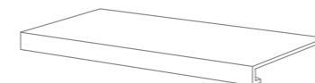
GRADONE - STEP 33x120x3,2x3,2 - 12 15/16 " x 47 1/4 " x 1 1/4 " x 1 1/4 " Nat. Rett. Pcs. Box. 2 - ML x Box 2,40
